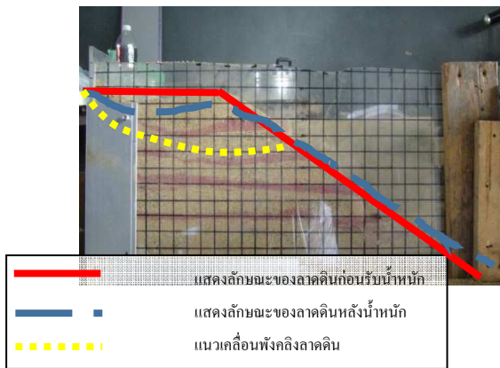
ภาพที่ 4.1 - 2 ลาดดินปกติหลังมีน้ำหนักบรรทุก
