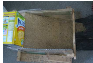
ภาพที่ 3.1 - 5 แสดงลักษณะการวางน้ำหนักบรรทุกลงบนคันคลอง
