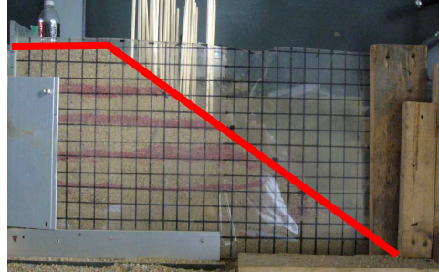
ภาพที่ 4.1 - 5 ลาดดินเสริมแรงด้วยเสาเข็มไม้ 4 แถว ก่อนมีน้ำหนักบรรทุก
