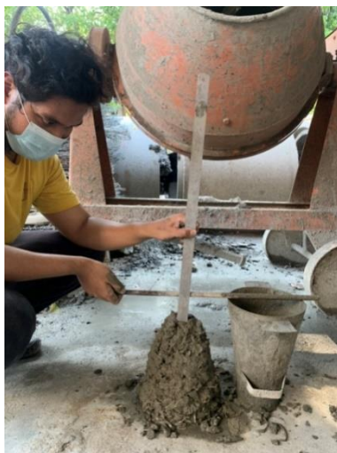
ภาพภาคผนวกที่ ข5 ยกกรวยทดสอบ ขึ้นตรง และทำการวัดค่าความยุบตัวของคอนกรีต
