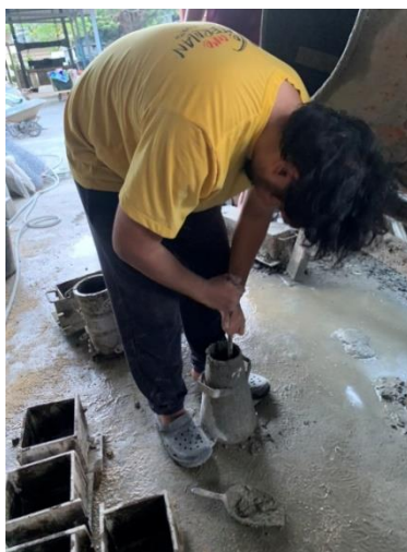
ภาพภาคผนวกที่ ข4 ทำการกระทุ้งด้วยเหล็กกระทุ้งจำนวน 25 ครั้งในแต่ละชั้น
