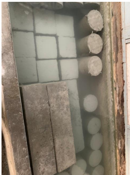
ภาพภาคผนวกที่ ข8 ทำการถอดแบบออกและนำคอนกรีตไปบ่มน้ำในบ่อบ่มคอนกรีต
