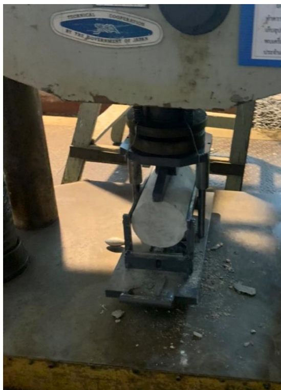
ภาพภาคผนวกที่ ข10 นำแท่งตัวอย่างคอนกรีตวางบนแท่นชุดทดสอบกำลังรับแรงดึง
