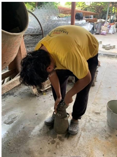
ภาพภาคผนวกที่ ข3 ตักคอนกรีตลงในกรวยทดสอบค่าความยุบตัวโดยแบ่งเป็น 3 ชั้น โดยปริมาตร
