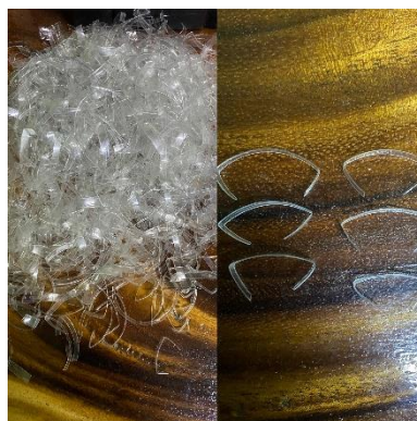
ภาพที่ 2.2 ลักษณะเส้นใยพลาสติกชนิด PET แบบปลายงอที่ใช้ในการวิจัย
