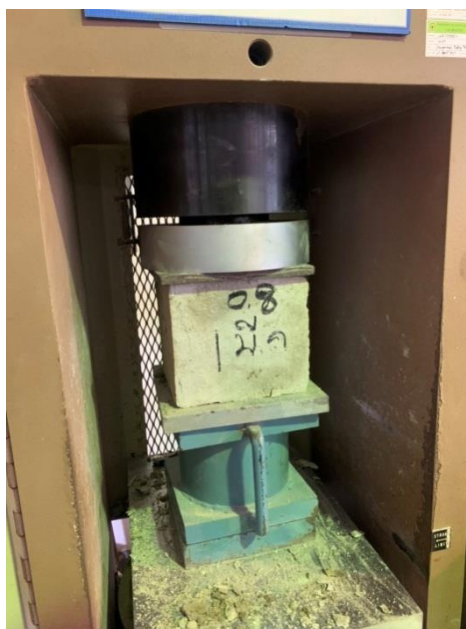
ภาพภาคผนวกที่ ข9 นำแท่งตัวอย่างคอนกรีตวางบนแท่นทดสอบกำลังรับแรงอัด
