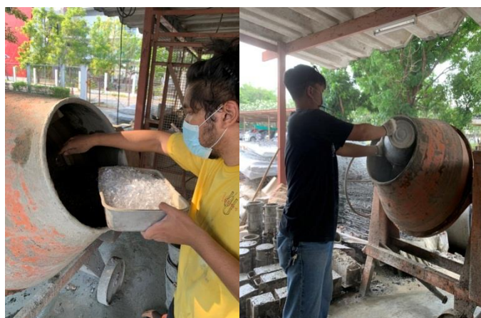
ภาพภาคผนวกที่ ข 1 ทำการเตรียม ชั่งวัสดุ สำหรับการผสมคอนกรีต
