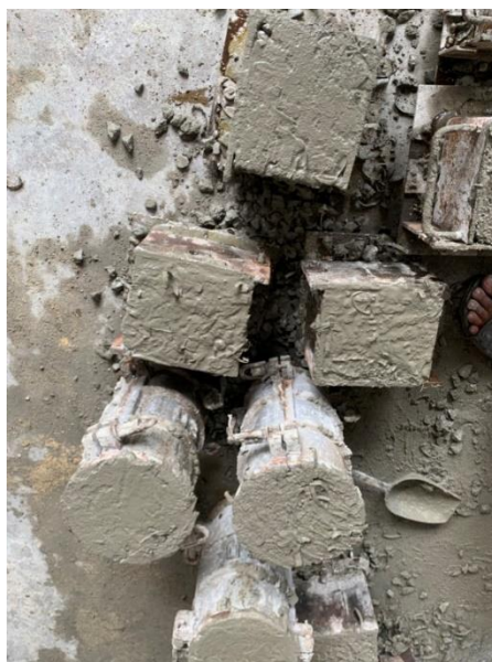
ภาพภาคผนวกที่ ข6 ทำการตัดคอนกรีตที่ผสมเสร็จแล้วใส่แบบหล่อคอนกรีตที่ทาน้ำยาทาแบบไว้
