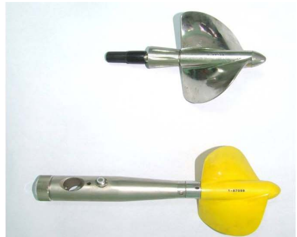
รูปเครื่องวัดกระแสน้ำ (Current Meter) แบบใบพัด (A-OTT) ใช้กับกระแสน้ำที่มีความเร็วสูง
